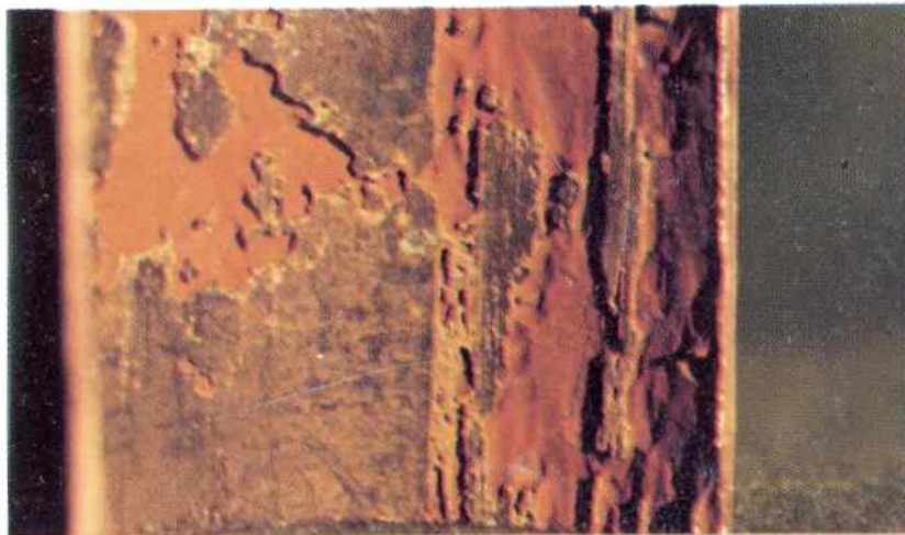
Figur 6. Typiskt angrepp genom erosionskorrosion i vattenledningsrör av koppar (Metallverken)
